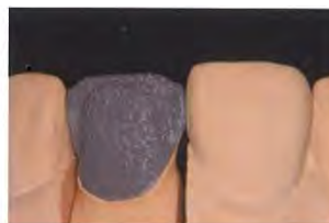
第2種純チタンを使用した前装冠の金属フレーム 適切な埋没材と鋳造機を選択することにより、リテンション ピースがよく再現されている。アルミン酸塩-マグネシア系埋 没材(シンピオン-TC, ニツシン)、チタン専用鋳造機(セレキャ ストスーパーR, セレック)。
