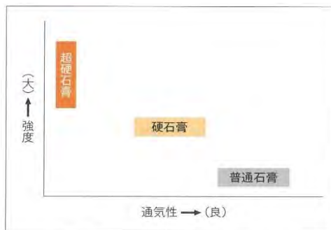
石膏の種類と通気性。感覚的にも理解できるであろうが、普通石膏が最も通気性が良く、固く締まるほど（硬石膏<超硬石膏）強度が上がると通気性は落ちる
