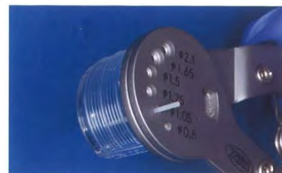
ファイバーポスト専用のカッターを用いた切断 [ファイバーカッタータイプ2, YDM]
